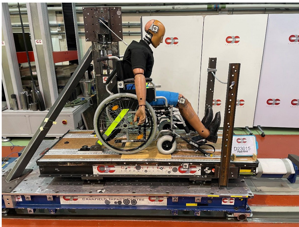
(Kørestol 0811300 under kollisionstest)
