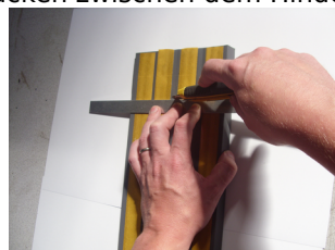
Abb. 2 Schneiden der Folie
