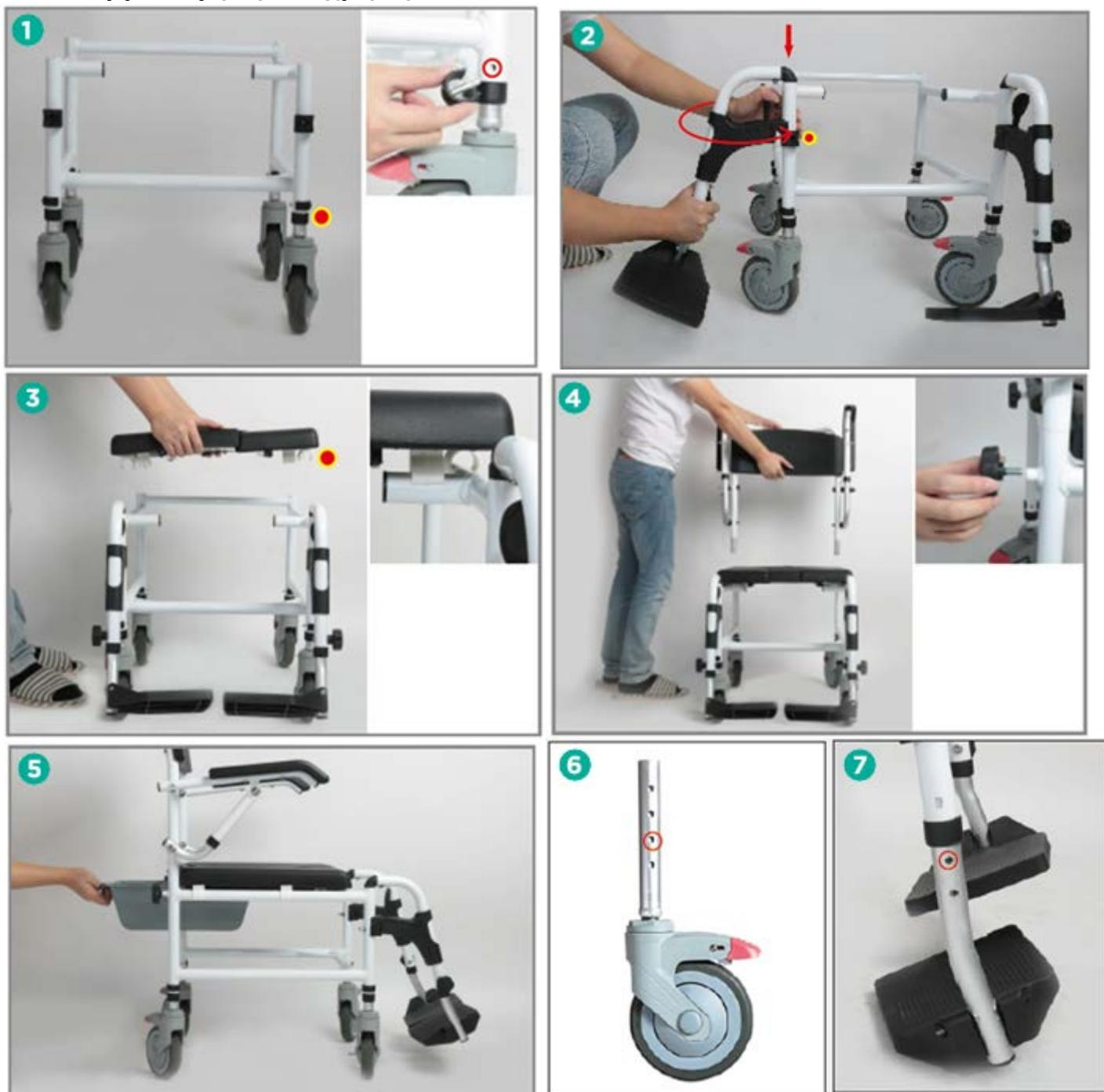
**Εικ.1** Τοποθετήστε τους 4 τροχούς στο πλαίσιο του καροτσιού. Ευθυγραμμίστε τις οπές στο σωστό ύψος και ασφαλίστε κάθε τροχό με έναν πείρο τροχού (στεφάνη με πείρο).
