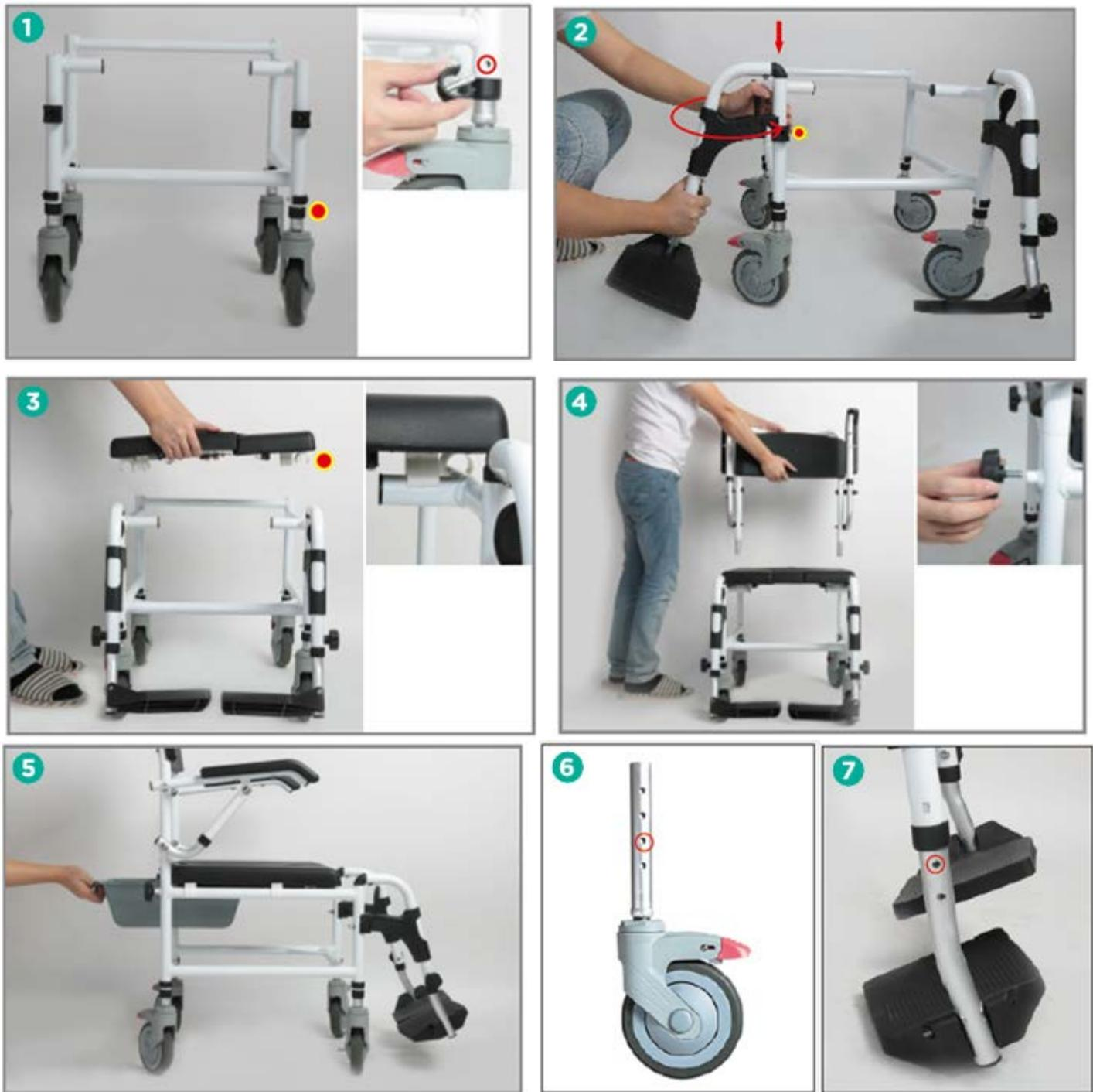
**Figura 1.** Installare le quattro ruote nel telaio principale. Allineare i fori all'altezza desiderata e bloccare ogni ruota con una fibbia di tipo C.
