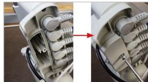
Montering af batteridæksel – Skru batteridækslet af/skrue det på plads ved at bruge den medfølgende skrue
