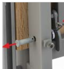
Fjernelse af gaffelstift, afstandsstykke og 'R'-clips
