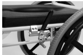
Bild 4: Montering av bromsarna på ramen
