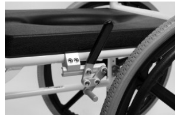
Rys. 4: Montaż hamulców do ramy.
